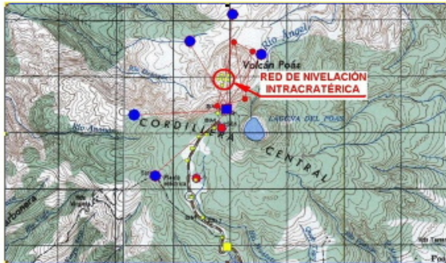
Figura 13: Red de deformación del volcán Poás. El cuadrado azul indica la ubicación del pilar y los círculos azules indican la ubicación de los reflectores fijos.
