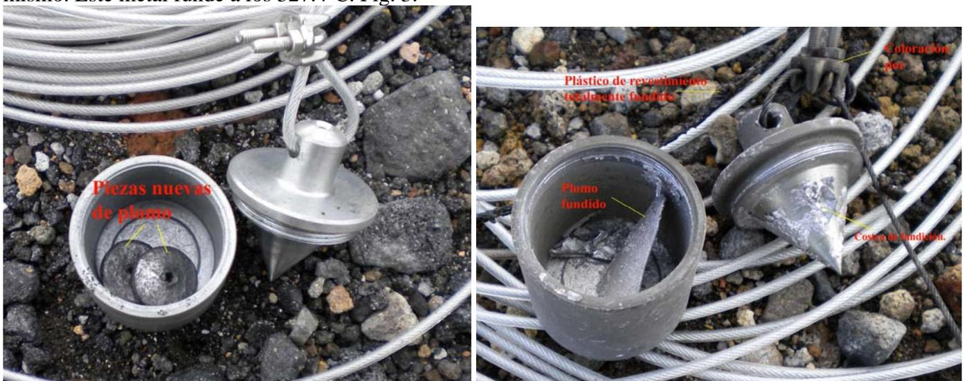
Fig. 3. Sistema de sonda, contenedor y plomo antes y después de exponerse por 5 minutos en la cavidad.
