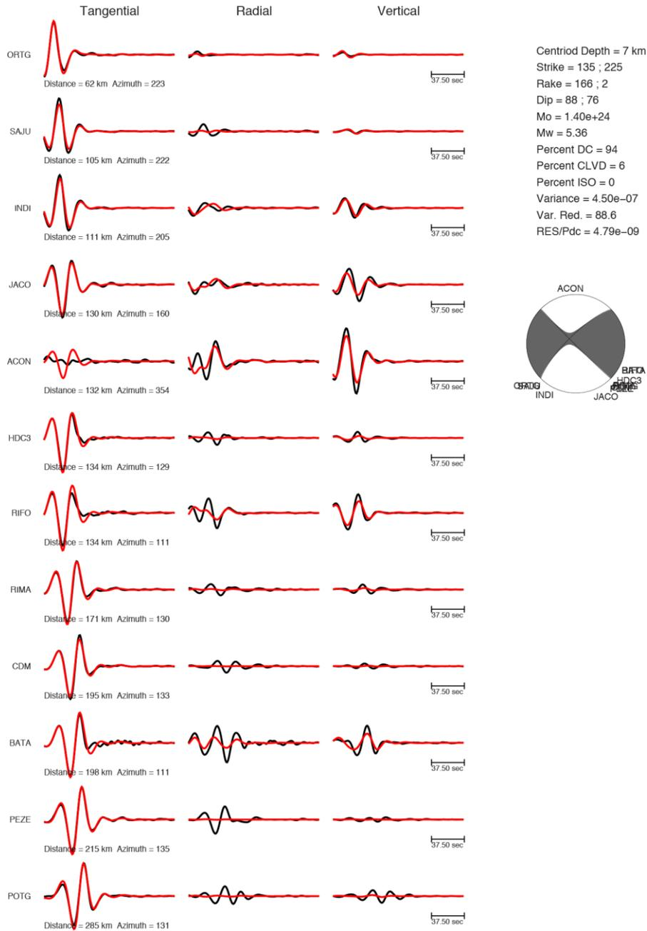
**Figura 8. Mecanismo focal generado en la inversión del tensor de momento sísmico.**
