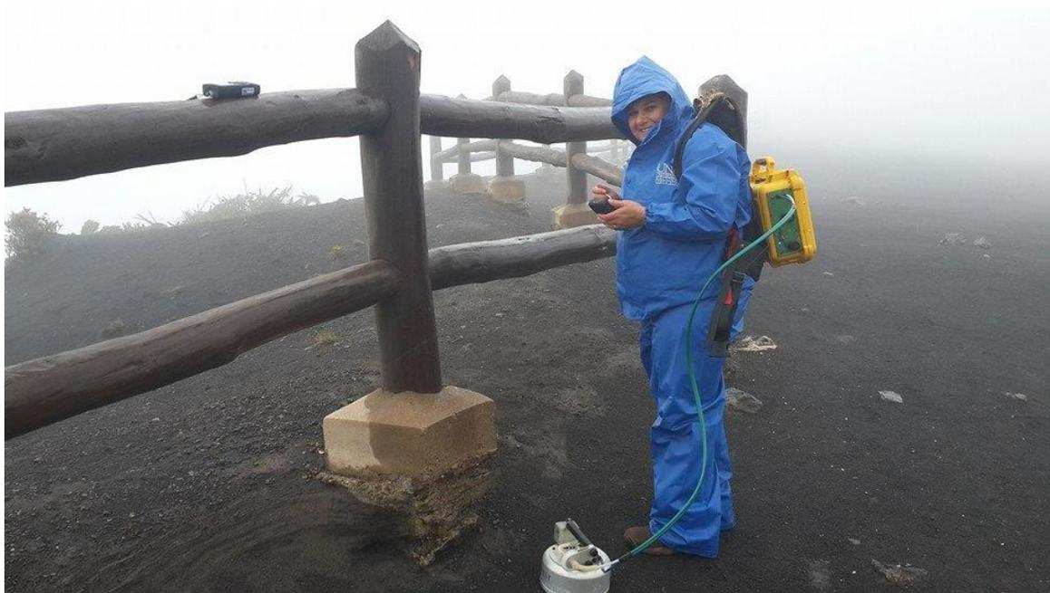
Figura 12. Medición in situ de dióxido de carbono y sulfuro de hidrógeno que difunden a través del suelo a lo largo del borde sur del Cráter Principal y del Cráter Diego de la Haya del volcán Irazú con flujómetro de gases portátil West Systems. Foto: María Martínez OVSICORI-UNA, 23 junio 2014).
