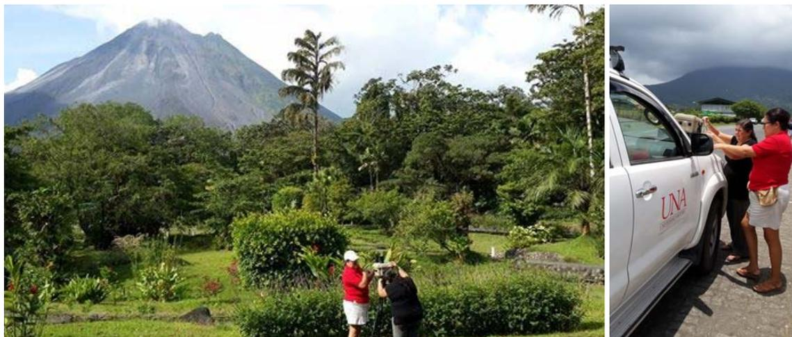
Figura 19. Medición del flujo de  $\text{SO}_2$  en la pluma del volcán Arenal (modo estacionario horizontal y transecto móvil) mediante espectrometría ultravioleta portátil FLYSPEC V3 por parte de las funcionarias del OVSICORI-UNA Floribeth Vega y Wendy Sáenz (Fotos: M.Martínez 8 abr. 2014).
