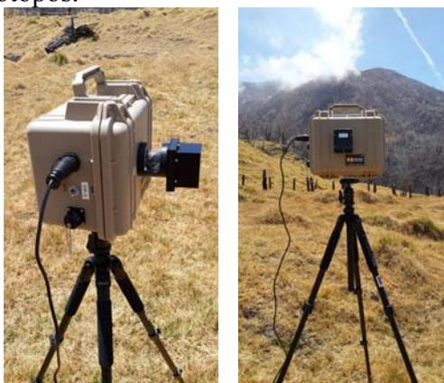
Figura 6. Medición del flujo de SO<sub>2</sub> en la pluma del volcán Turrialba (modo estacionario vertical) mediante espectrometría ultravioleta portátil FLYSPEC V3 (Fotos: M.Martínez, 25 mar.2014)
