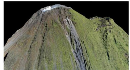
Figura 32: Modelo Digital de Terreno en 3D de la cima del Arenal (cráter C a la izquierda, cráter D a la derecha) reconstituido a partir de ortofotogrametría mediante dron. Trabajo gracias al apoyo de Ian Godfrey, Universidad de South Florida.
