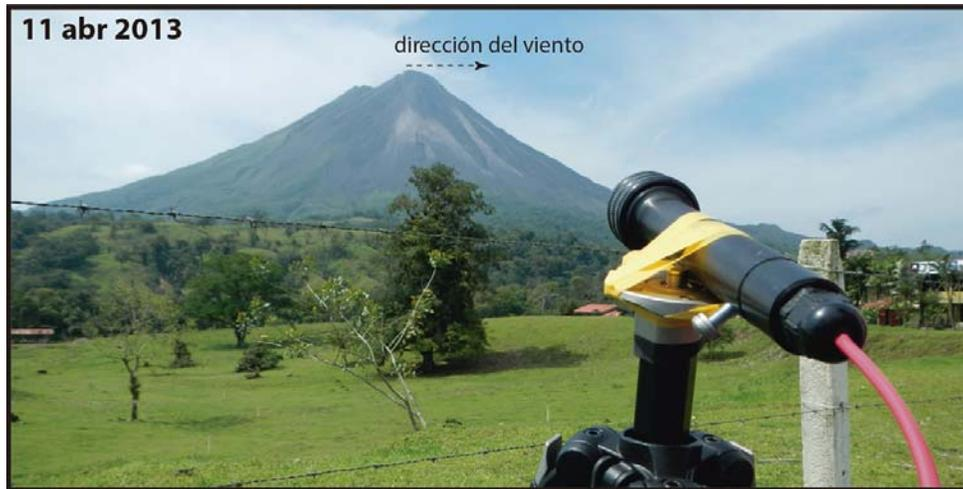
Figura 27: Medición de la concentración en  $\text{SO}_2$  en la pluma del volcán Arenal por absorción ultravioleta gracias a un DOAS portátil (Foto: G.Avard).
