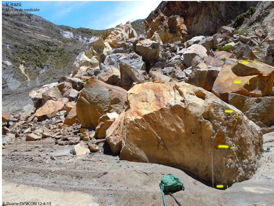
*Figura 17: Marcas de medición del nivel del futuro lago al fondo del Cráter Principal (Foto: E.Duarte, el 12 de abril del 2013).*
