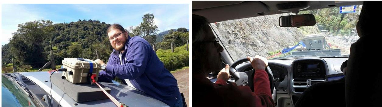
Figura 5. Medición de SO<sub>2</sub> mediante FLYSPEC móvil a lo largo de la ruta entre Finca La Central y Finca La Picada. A la izquierda el MSc Martijn Keizer instalando el FLYSPEC. A la derecha Keizer y Javier Pacheco realizando los transectos pasando debajo de la pluma volcánica con el FLYSPEC.
