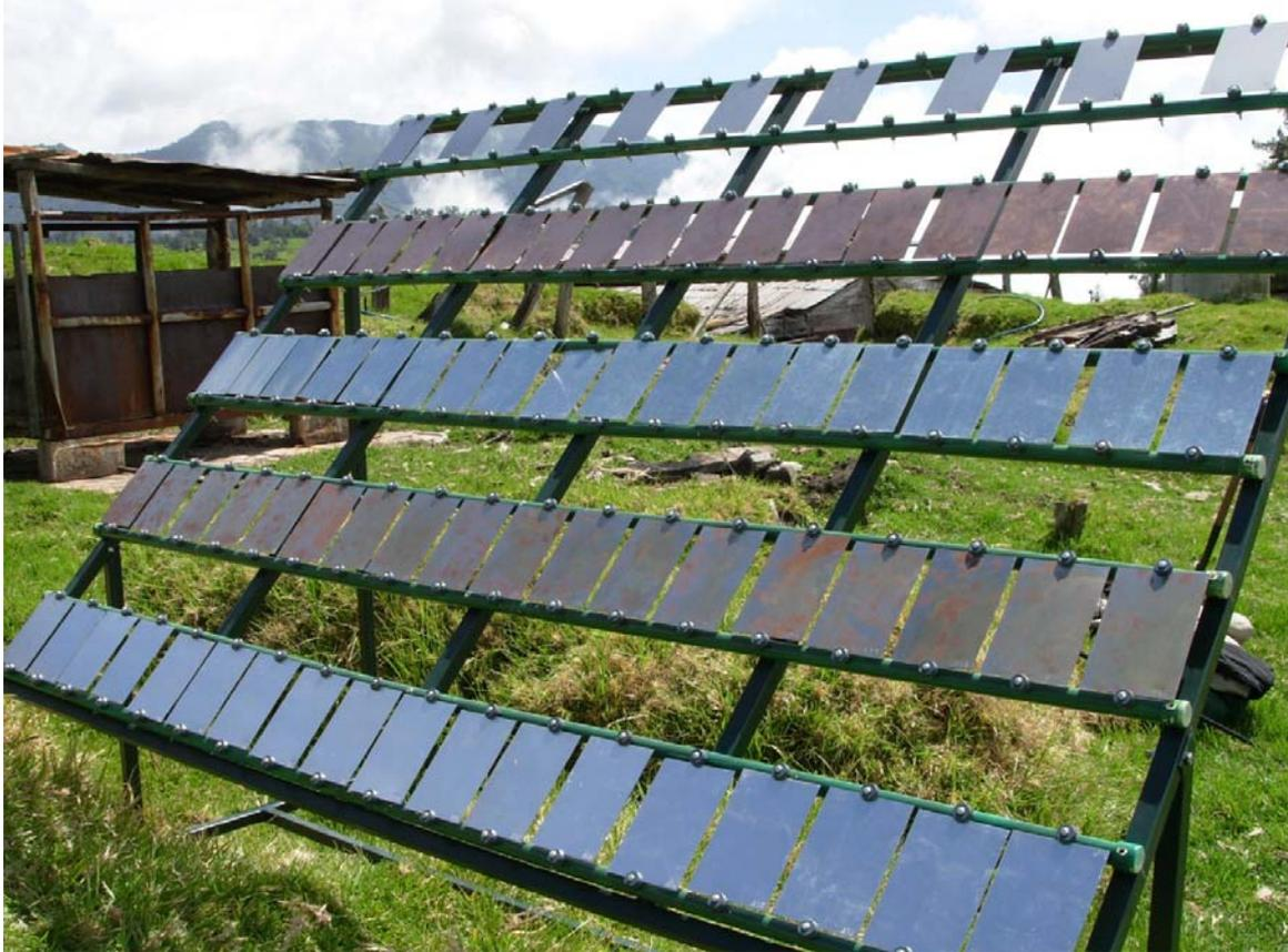
Fig. 4. Plataforma con probetas para la cuantificación mensual.
