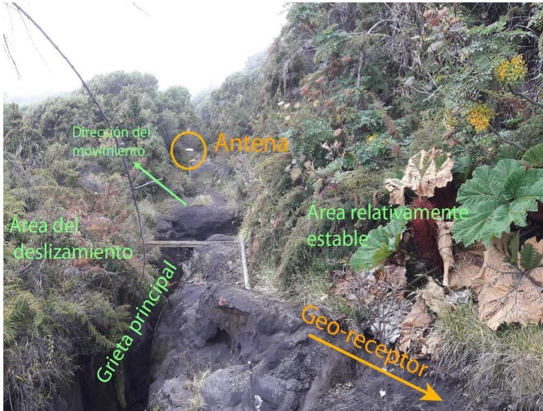
Fig 2. Instalación de una antena de GPS permanente en el bloque en movimiento con el receptor, medio de comunicación y alimentación en la parte estable.
